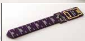
Temperatur- och fuktsensorn kostar bara 20 kronor i komponenter.
